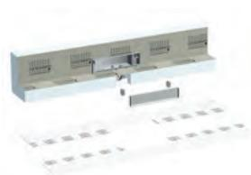
Les éléments d'écoulement de douche permettent, grâce au déplacement du siphon dans le mur, d'avoir une surface au sol en continue.
